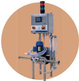
L'introduzione di un **dosatore di gomma arabica** in cantina consente di dosare l'additivo con estrema precisione, migliorando la qualità del vino e assicurando una riduzione degli sprechi.
