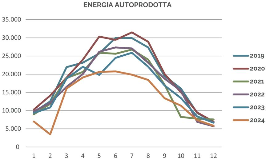
La cantina è munita di un vasto parco fotovoltaico. All'impianto iniziale di 192 kW è stato aggiunto un ulteriore nuovo impianto da 468 kW, per un totale di **660 kW** e una copertura del **70-75%** del fabbisogno energetico. L'obiettivo è contribuire considerevolmente al risparmio energetico ed un conseguente basso impatto ambientale.
